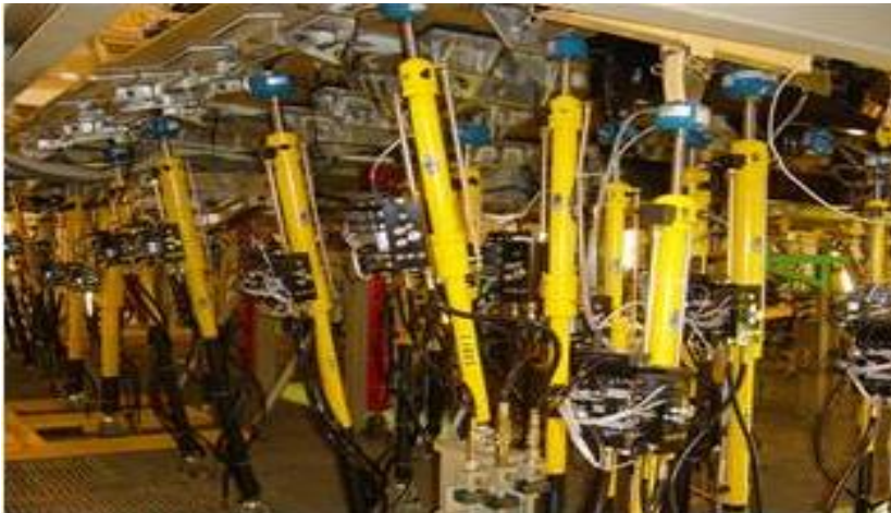
BAE Systems: Thyphoon – 112 Servo Válvulas no Teste Estrutural
