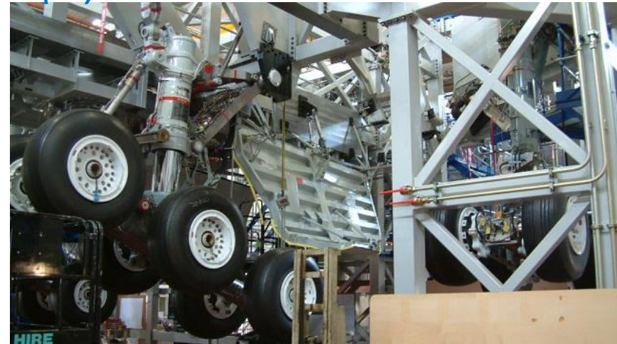
AirBus: Teste do Trem de Pouso A-380 incríveis 220 milhões de ciclos entre Set-2009 e Out-2015
